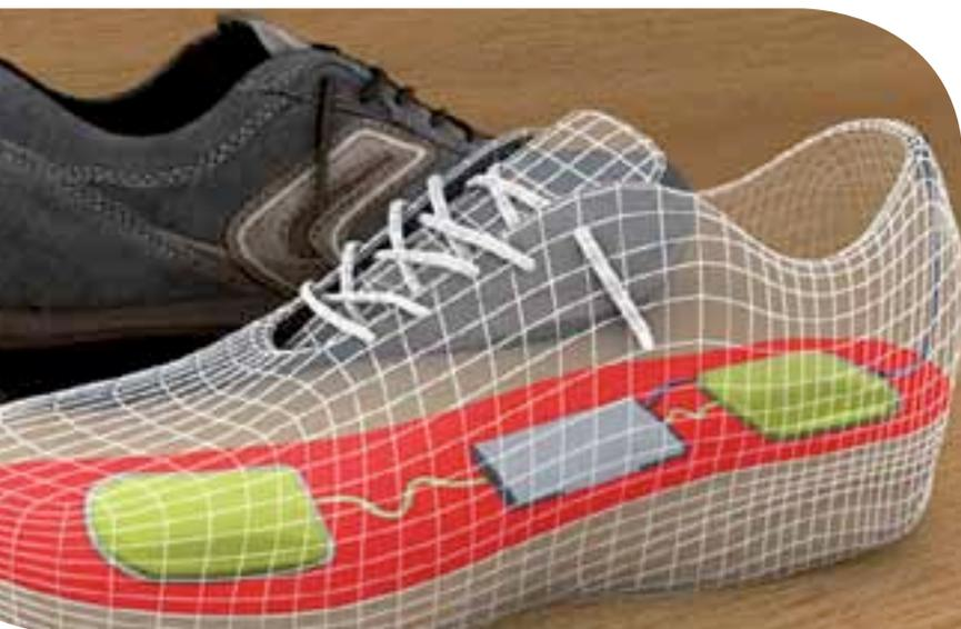
También encontramos con mayor difusión los InStep Nanopower, unos zapatos tenis con dos sensores que captan la energía cinética generada por la pisada del usuario, transformándola en una corriente de hasta 20 Watts. A través de Wi-Fi, esta energía pasa a los dispositivos móviles ampliando el rendimiento de su batería.
