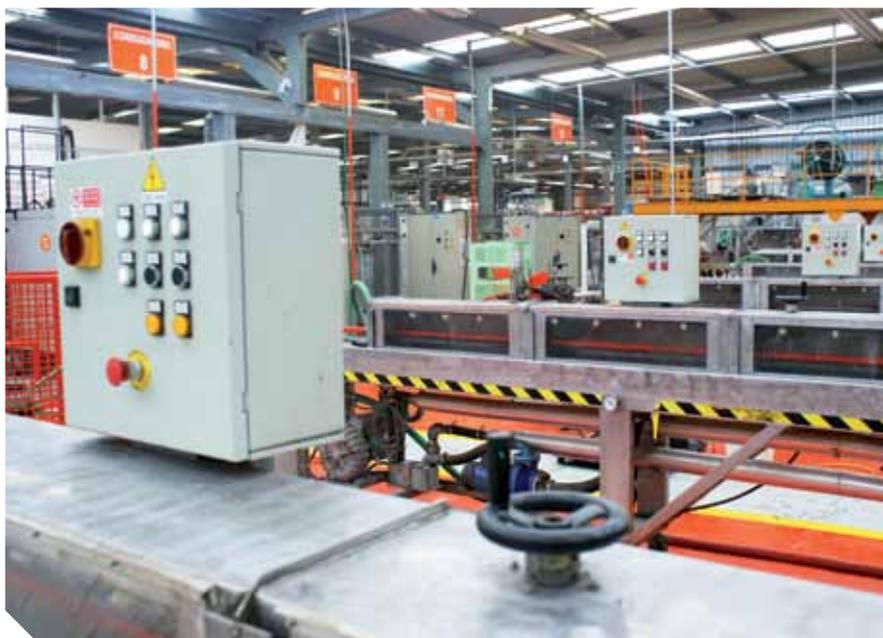
Más adelante, se invirtió en máquinas veloces y en tolvas para las diferentes materias primas (colocadas en la máquina), con lo que eliminamos el mezclado. Actualmente, la máquina está programada para dosificar la cantidad necesaria de cada material y realizar el mezclado en su interior, mientras los plastifica para formar el tubo.
