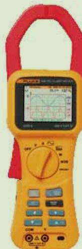
Reúne las ventajas de un analizador de calidad eléctrica, un registrador de calidad eléctrica y una pinza amperimétrica en un solo instrumento; ideal para la monitorización de cargas electrónicas. Además, el diseño de la pinza amperimétrica de efecto Hall permite realizar también medidas de CC, evitando el tener que desconectar el circuito de corriente.
