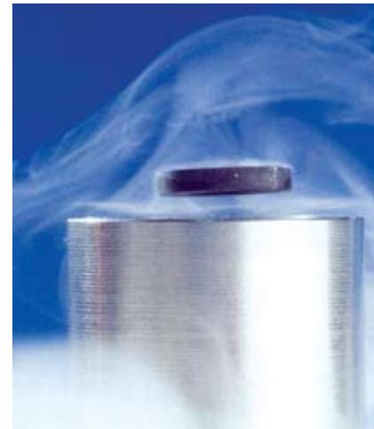
El tren experimental "maglev" MLX01, actualmente sometido a pruebas por el Instituto de Investigación Técnica del Ferrocarril de Japón (RTRI, por sus siglas en inglés), utiliza superconductores de baja temperatura "modelo antiguo" que requieren helio líquido como refrigerante. Los superconductores de alta temperatura pueden utilizar en cambio nitrógeno líquido, el cual es más barato, más abundante, y más fácil de manejar.
