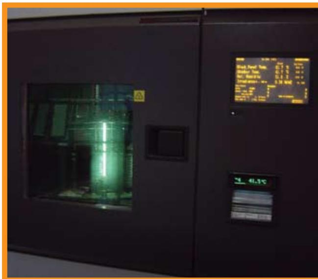
Figura 2. Proceso de la prueba sobre resistencia a la intemperie del aislamiento o la cubierta de conductores eléctricos. [NMX-J-553]
