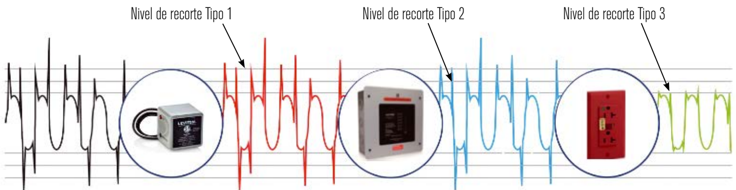
Imagen 1. Recorte o atenuación de una sobretensión transitoria.
