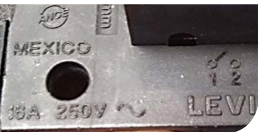
Imagen 4. Indicación de tensión y corriente nominal.
