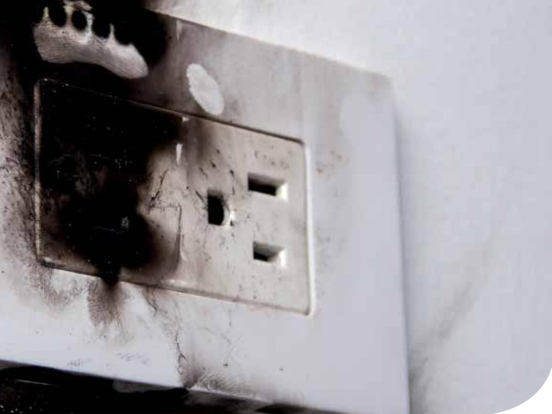
Un apagador en mal estado representa un riesgo de incendio por cortocircuito, o de descarga eléctrica al accionarlo, con resultados fatales.
