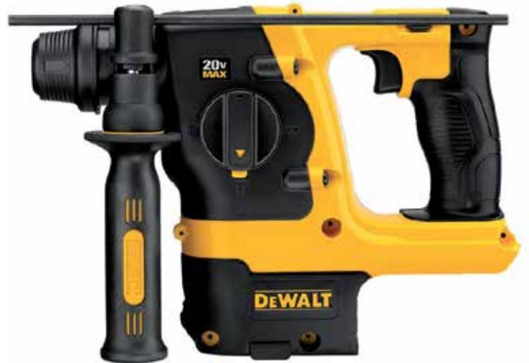
El DCH213B es ideal para instalar anclajes y fijaciones en concreto, ladrillo y mampostería desde 4 mm hasta 20 mm. Incluye martillo SDS+, mango lateral de 360° y barra de profundidad. Especificaciones: Voltaje 20 V, potencia de salida 300 W, velocidad sin carga 0-1100 rpm, energía de impacto 2 J y alcanza 4,200 golpes por minuto.
