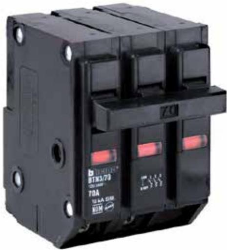
La línea de interruptores BTPLUG ofrece una gama completa de interruptores automáticos destinados a proteger a las instalaciones eléctricas contra fallas de sobrecarga y corto circuito (protección termomagnética). Los interruptores BTPLUG están disponibles en versiones de 1, 2 y 3 polos de montaje enchufable (Plug in - 3/4") con calibraciones de 10 hasta 100 A y capacidad interruptiva de 10 kA.
