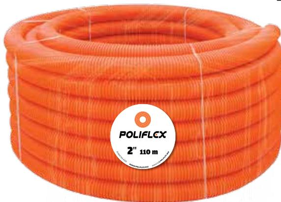
**BANCO DE DUCTOS.** Se deben emplear ductos de polietileno de alta densidad, como el **POLIFLCX** PAD en rollo (disponible en 2", 3" y 4"). En los Planos de Proyecto de Obra Civil se indicará el diámetro, número de ductos y profundidad conforme a las normas. La unión entre los bancos de ductos y los registros debe ser hermética. En terrenos con nivel freático muy alto, se utilizarán ductos de PAD o PADC en tramos continuos entre registro y registro.
